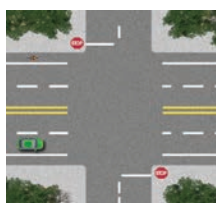
Cruces peatonales no marcados
