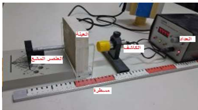
الشكل 3. يبين منظومة القياس وهي عداد جايجر - ميلر (G-M Counter) والعينة ويقابلها العنصر المشع
