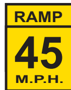
Velocidad recomendada en la rampa
