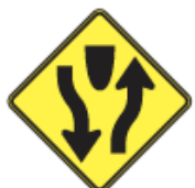
Comienzo de Carretera Dividida
