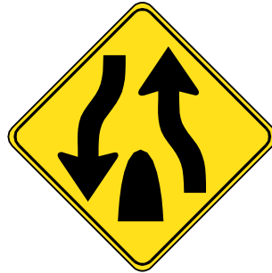
Termina carretera dividida, comienza carretera de dos carriles.
