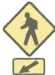
Cruce de peatones
