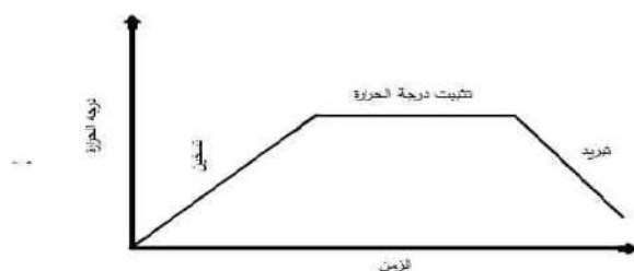
الشكل (5) يوضح دورة المعالجة الحرارية
