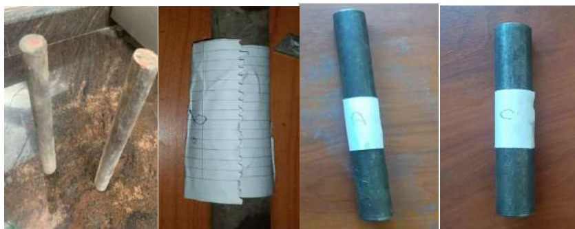
شكل (7) صور لعينات الحديد متوسط الكربون التي تم اختبارها
