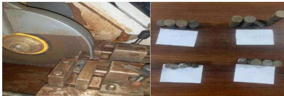
شكل (9) المنشار الكهربى المستخدم لقطع العينات إلى (4) أجزاء لكل عينة ليتم معالجتها وقياس صلابتها
