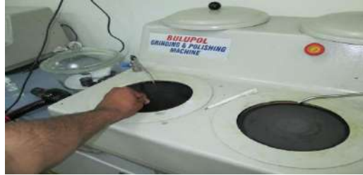
شكل (10) جهاز السنفرة
